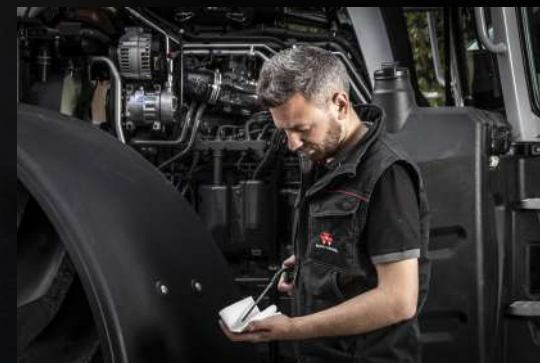
Esisild ja kitsas kapott hõlbustavad juurdepääsu õli määrdavdale ja -filtrile.
