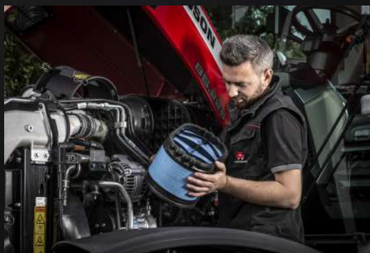
Mootori õhufilter on hõlpsasti ligipääsetav ja puhastatav.
