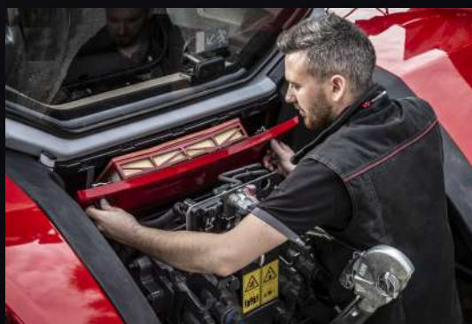
Kabiini õhufiltri puhastamine on lihtsam parema juurdepääsu tõttu.
