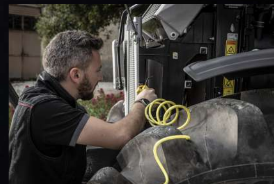
Jahutuspakett on hõlpsasti ligipääsetav, et muuta puhastamine kiiremaks ja lihtsamaks.
